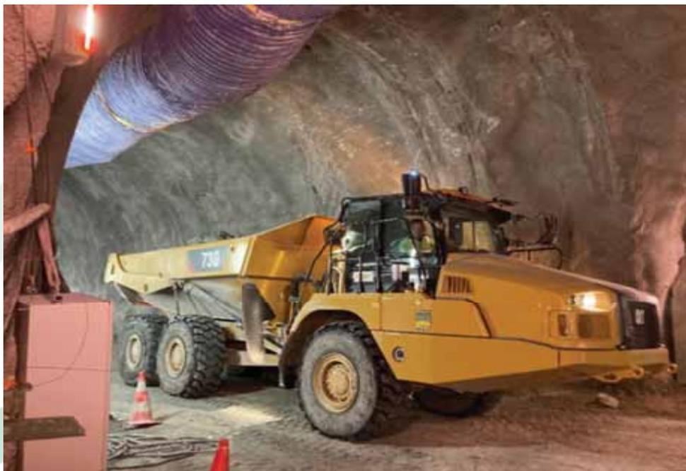
Transport des matériaux d'excavation issus de la galerie de connexion à la chambre de pied de puits
