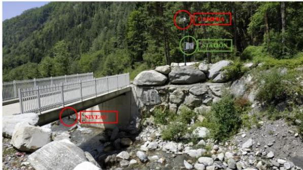
Figure 69 : Détecteur de niveau d'eau sur le Bugeon
