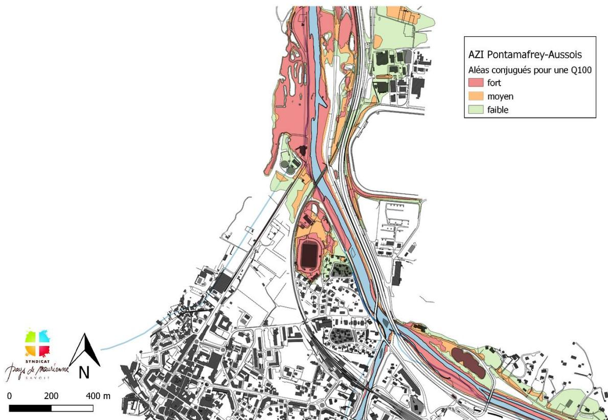
Figure 32 : Aléa pour une crue centennale de l'Arc au niveau de Saint-Jean de Maurienne sans scénario de rupture de digues (AZI, 2009)
