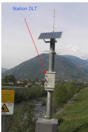
Le **Glandon**, le **Saint-Bernard** et le **Saint-Julien** sont également équipés d'un dispositif de laves géré par la SFTRF. Sur le Glandon, le signal permet de déclencher un feu autoroutier. Pour les autres dispositifs, lorsque le capteur se déclenche, le signal est transmis au PC sécurité de la SFTRF.
