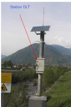
Figure 70 : Dispositif d'alerte de laves torrentielles sous le pont SNCF, au niveau de la Ravoire à Pontamafrey (RTM)
