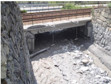
Figure 70 : Dispositif d'alerte de laves torrentielles sous le pont SNCF, au niveau de la Ravoire à Pontamafrey (RTM)
