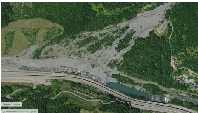
Figure 18 : Effet de la dynamique du Poucet sur l'Arc : restriction de la capacité hydraulique de l'Arc et effet plan d'eau en amont (IGN 2016)
